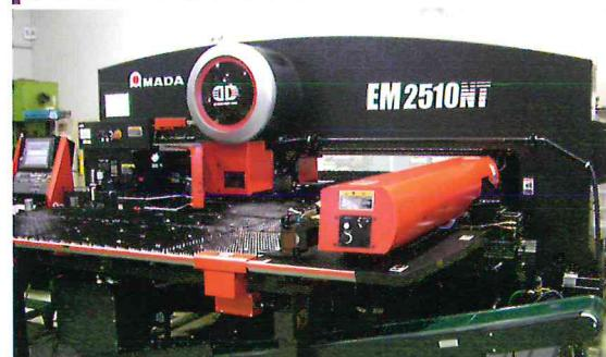
NC制御によって、任意の金型で材料の所定の位置に所定の打ち抜き、
