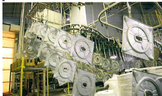
耐候性、密着性などに優れたポリエチレン系塗料を使用。前処理は磷酸亜鉛処理。各種公害防止設備を完備した塗装ラインです。
