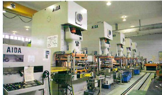
照明器具用大型板金部品を自動搬送生産しています。製品は、自動搬
